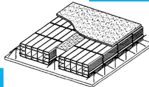
a) Lastre tralicciate ad armatura lenta e blocchi di laterizio (predalle)
