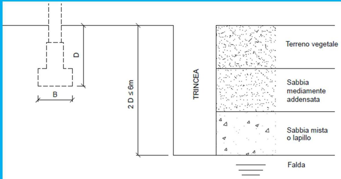
Trincea per la determinazione della stratigrafia e della presenza di falde acquifere
